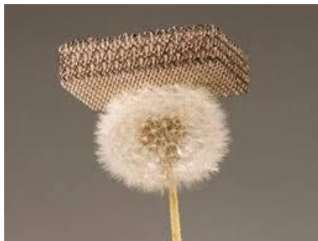
Obr. 8. 6. Aerografit má extrémně malou hustotu [7]
