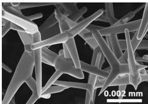
Obr. 8.5. Struktura aerografitu [7]
