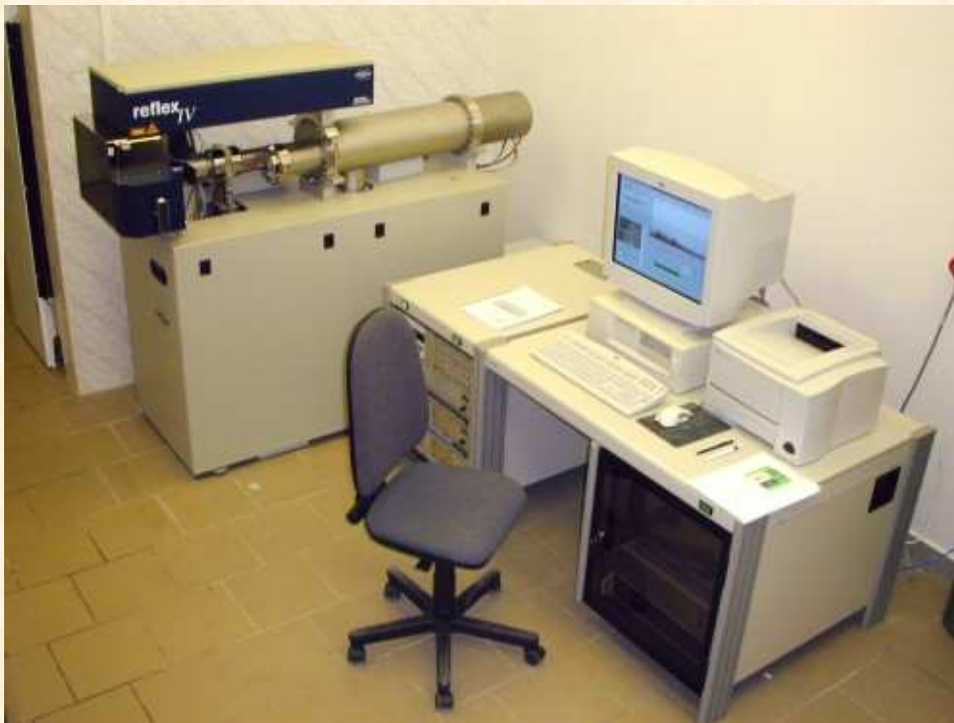
MALDI-TOF hmotnostní spektrometr Reflex IV od firmy Bruker umístěný v CL OFGP PřF MU
