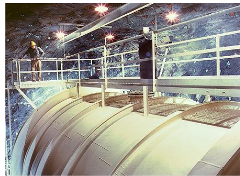
Davisův experiment běžel nepřetržitě od roku 1970 do roku 1994 a za tu dobu vzniklo v Davisově cisterně díky slunečním neutrinům asi 2200 atomů radioaktivního argonu. Foto R. Davis.
