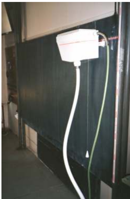
Obr. 2 Iž Sestavený funkční model - nádržka s připojenými hadicemi
