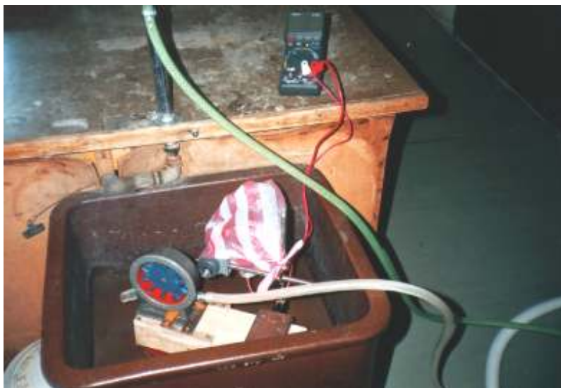
Obr. 3u Sestavený funkční model - připojení hadic k turbíně, upevněné na stojanu s tachogenerátorem připojeným k měřicímu přístroji, a zdroji vody
