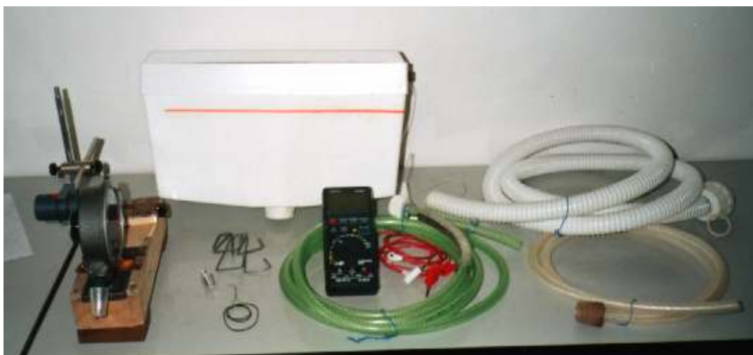
Obr. 4u Součásti materiálového sestavení funkčního modelu elektrárny
