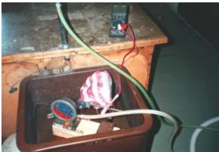
Obr. 3Iž Sestavený funkční model - připojení hadic k turbíně, upevněné na stojanu s tachogenerátorem připojeným k měřicímu přístroji, a zdroji vody
